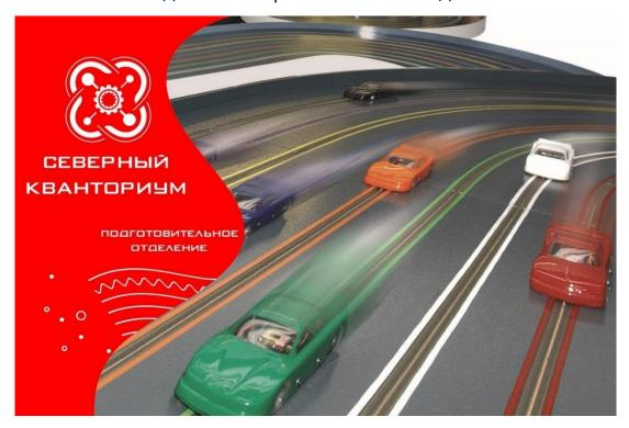
Трассовый моделизм — это разновидность автомодельного спорта. Трассовая модель автомобиля — модель с внешним питанием, движется по специальной трассе, направление модели задает паз в трассе, а питание модель получает от токонесущих шин. Спортсмен управляет только скоростью модели при помощи специального пульта.
