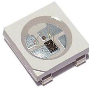
Светодиод, с которым мы будем работать на данном занятии, — **WS2712B**. В нём уже светящийся элемент сразу подсоединён к чипу. Наружу выведены ножки питания, общей шины, а также цифровой вход и выход. Чаще всего такие светодиоды размещают на лентах.
